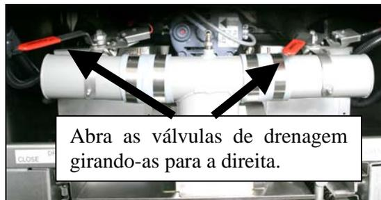
**Abra as válvulas de drenagem da cuba e drene o óleo para o tacho de filtragem.**
